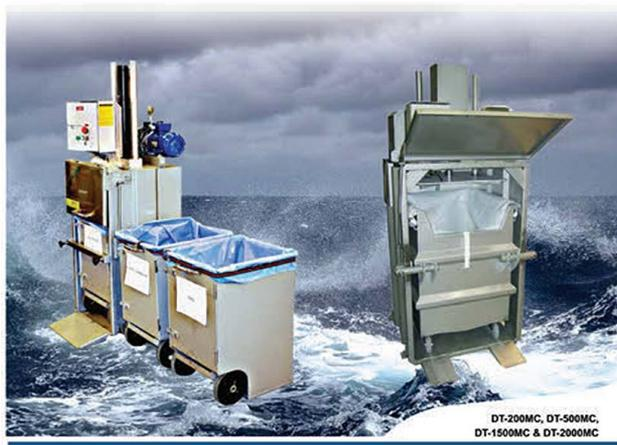
Применяются для уплотнения различных типов отходов: картона, пищевых отходов, бумаги, пластика, консервных банок и т.д.
